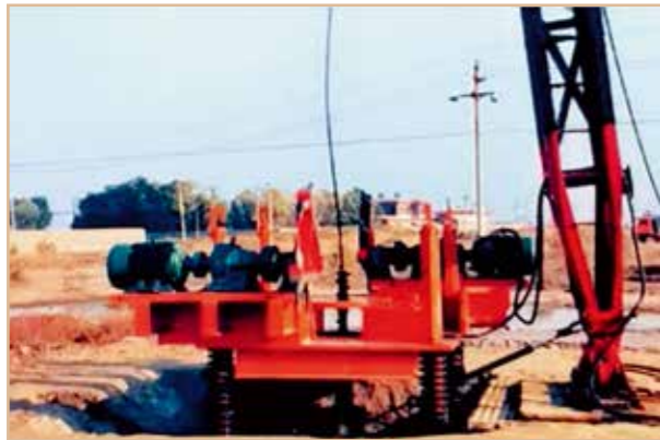
图4 胜利油田谐波振动井口装置
